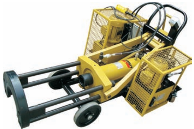
Sistema de levantamento do extrator hidráulico através de bomba motorizada
